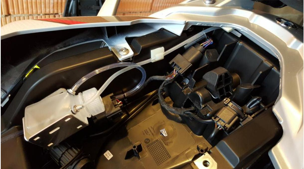
Die Elektronik am ABS Block befestigen (Klettband). Die Kabel nach oben positionieren.
