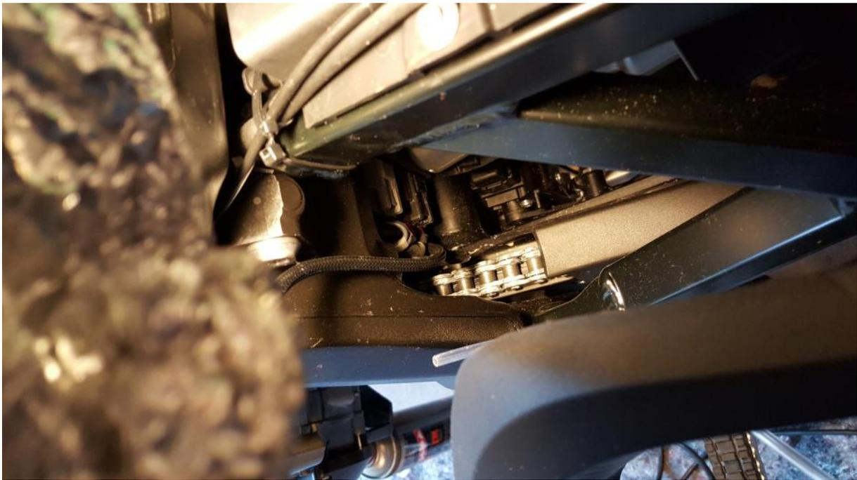
Jetzt die Ölleitung nach oben Richtung Ölpumpe führen.
