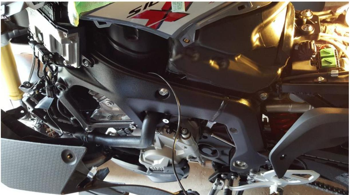
Jetzt den Öltank mit Hilfe von einem Stück Klettband im Staufach befestigen. Den Entlüftungsschlauch mit zwei Klebeplättchen in das Heckverkleidungsteil führen. Er muss am höchsten Punkt der Installation liegen!
