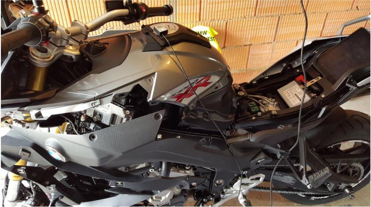
Jetzt das Kabel des Displays mit den original Kabeln und dem Kupplungszug führen und mit den beiden Gummilaschen befestigen. Darauf achten, dass im Bereich des Lenkkopfes genug Kabellänge zur Verfügung steht. Lenkerfreigang in beide Richtungen prüfen!
